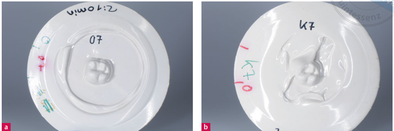
Abb. 4 Ergebnisse aus Tiefziehversuchen: a erfolgreiche Abformung des okklusal reduzierten Zirkonoxidgerüsts; b Fehlversuch mit Faltenwurf in der Folie durch Druckluftzufuhr.
