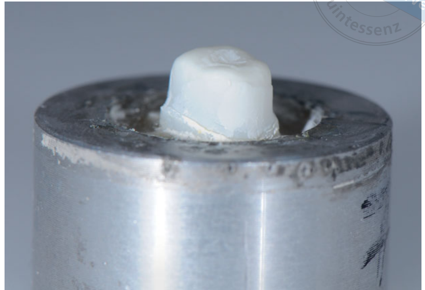
Abb. 9 Kohäsiver Bruch nach Kronenabzugsversuch mit restlichem Befestigungsmaterial am Zirkonoxidstumpf.
