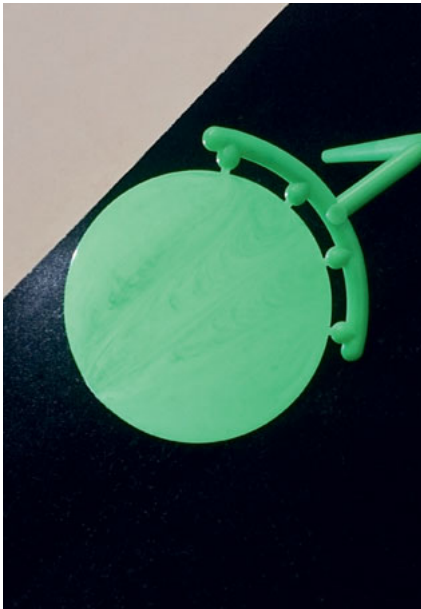
Abb. 2 Spritzgießversuch mit eingefärbtem Polyethylen.
