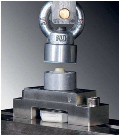
Abb. 8 Kronenabzugsversuch zwischen PEEK und Zirkonoxidgerüst.
