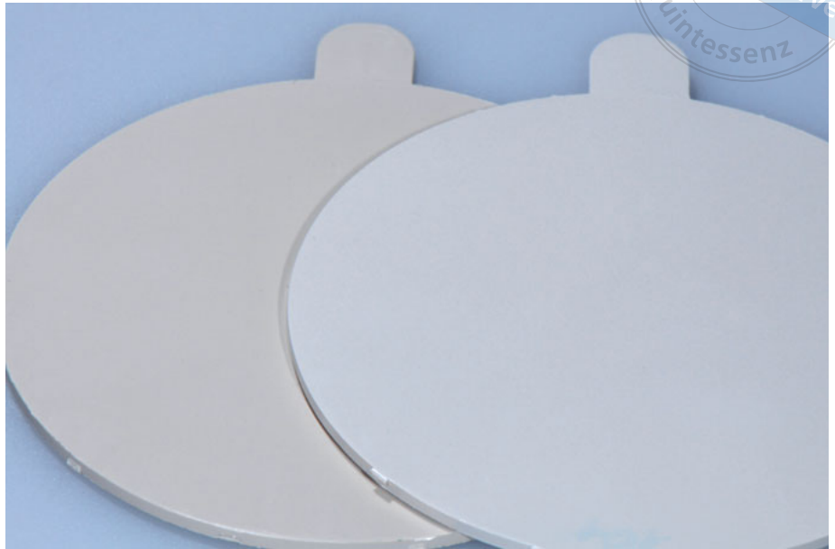
Abb. 3 Spritzgegossene PEEK-Folien mit final entwickelter Rezeptur und 1,4 mm Schichtstärke.
